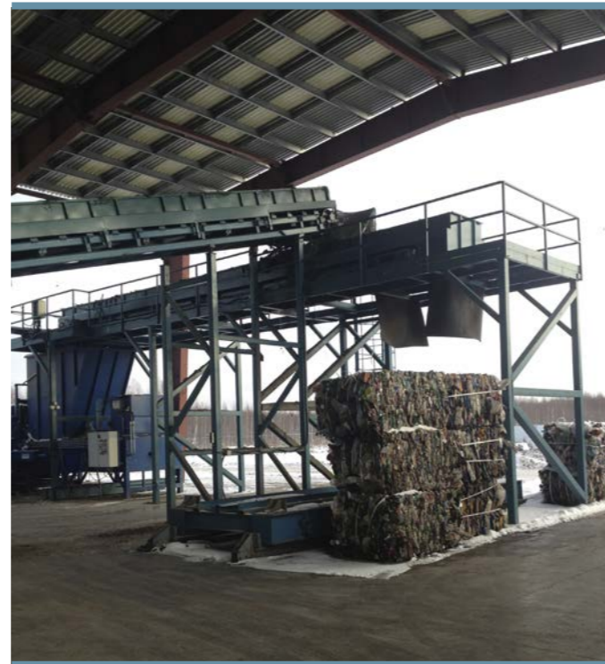
Нижегородская область, Городецкий муниципальный район. Мусоросортировочный комплекс мощностью 100 тыс. тонн в год
