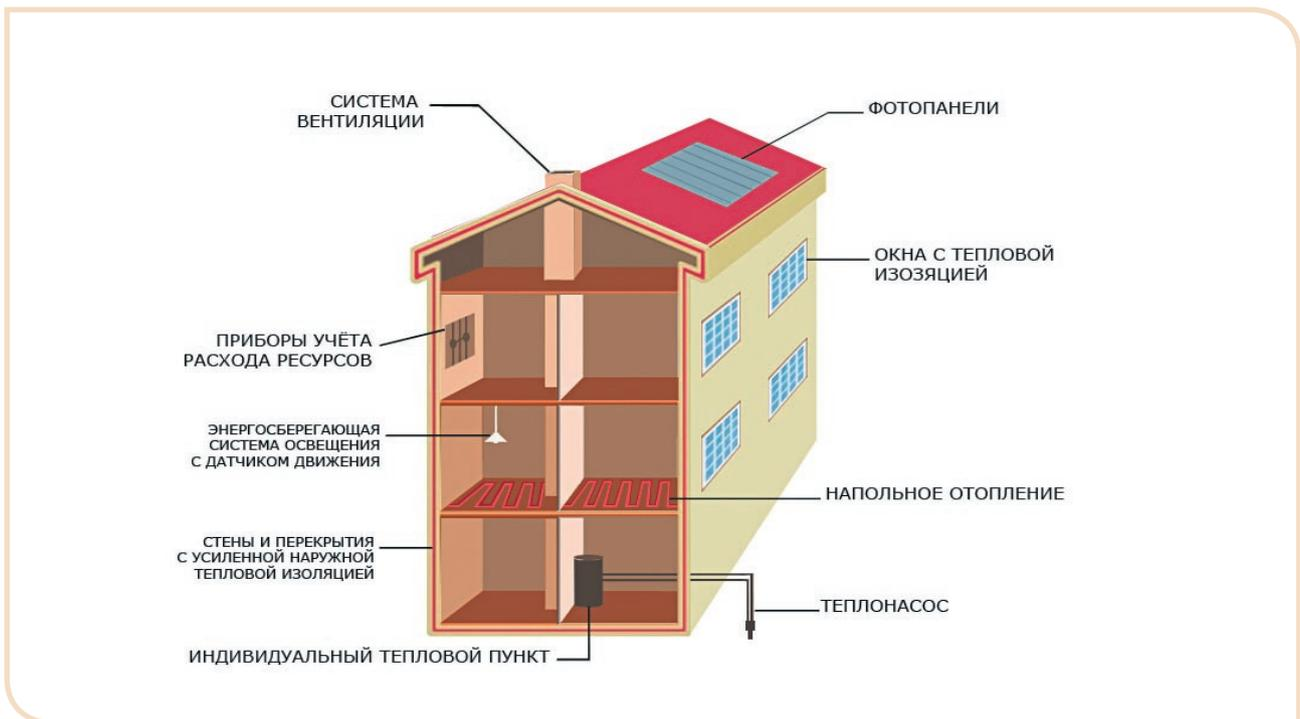
Рис. 15. Пример применения энергоэффективных технологий
