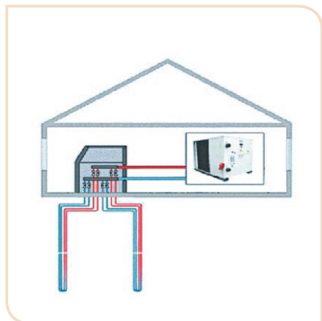
Рис. 16. Отопление за счет энергии Земли с помощью теплового насоса
